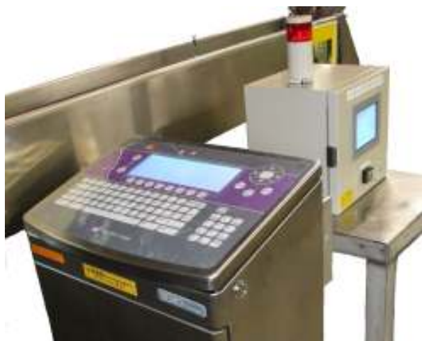
インクジェット制御盤
