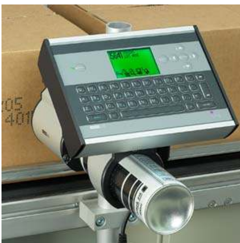
段ボール用 超小型インクジェットプリンター
